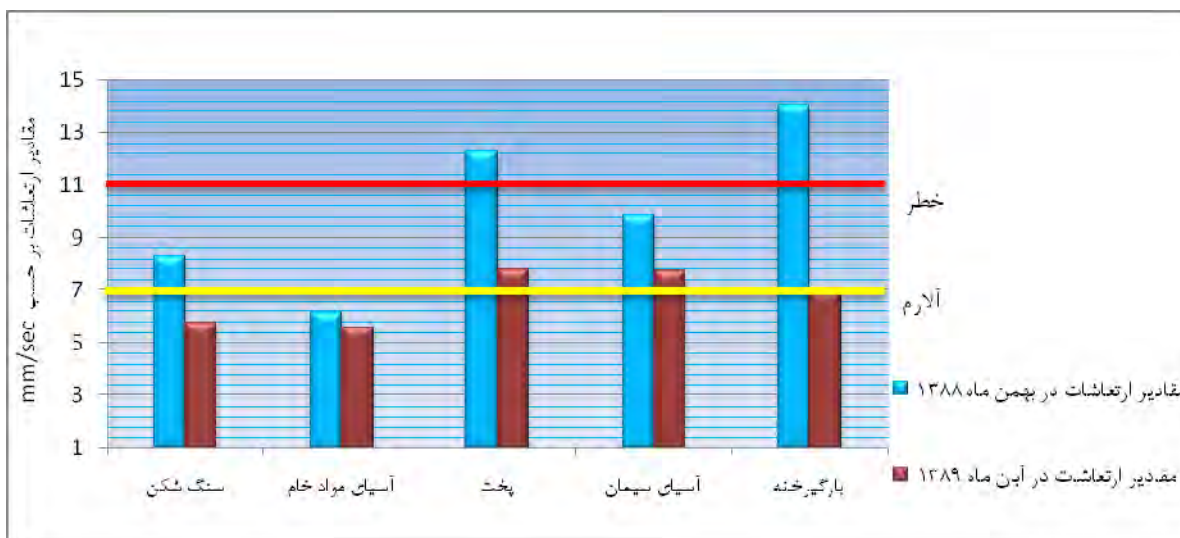
نمودار شماره 6 - مقایسه تغییرات میانگین ارتعاشات بگ فیلترهای خط تولید به تفکیک دپارتمان
