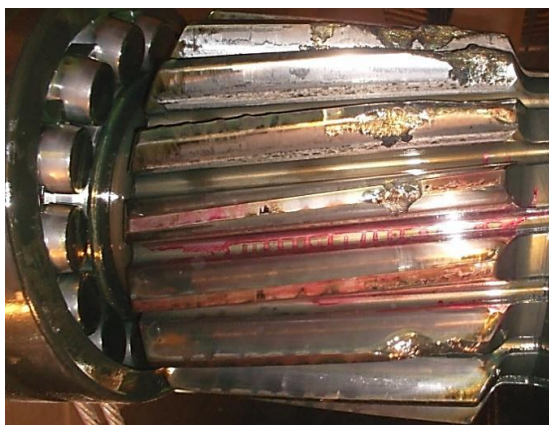
شکل 9. تصویر خرابی چرخ‌دنده محور میانی
