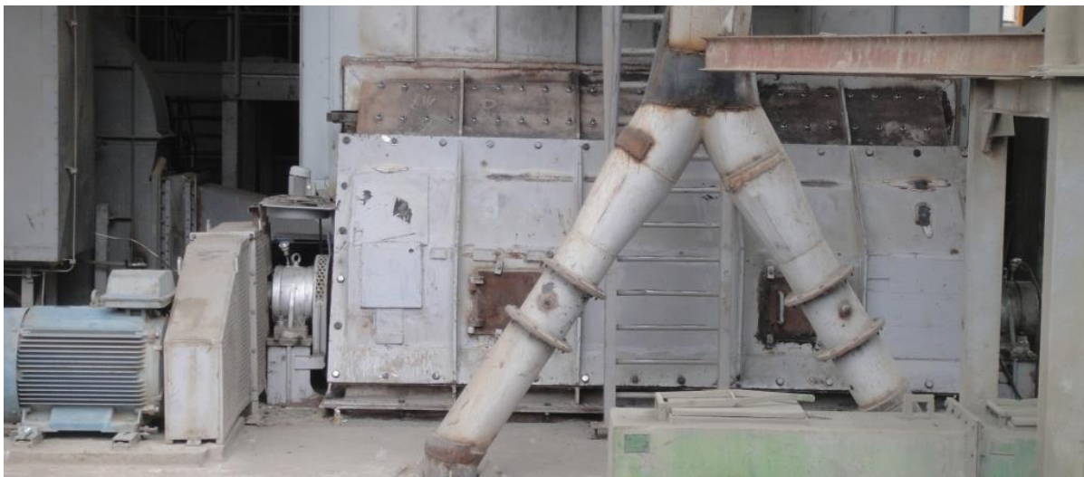
شکل ۱ - تصویر کلینکر کراشر کارخانه سیمان زاوه
