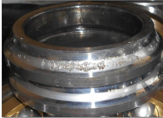
شکل 14- تصویر حلقه داخلی آسیب دیده یاتاقان کمپرسور
